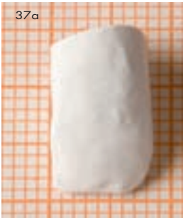
Abb. 37a Der überdimensionierte Grünling aus Zirkonoxid (Lava, 3M Espe) in gefrästem und ungesintertem Zustand ... Abb. 37b ... und das fertig gesinterte Kronengerüst
