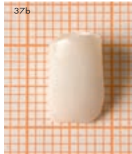
Abb. 37a Der überdimensionierte Grünling aus Zirkonoxid (Lava, 3M Espe) in gefrästem und ungesintertem Zustand ... Abb. 37b ... und das fertig gesinterte Kronengerüst
